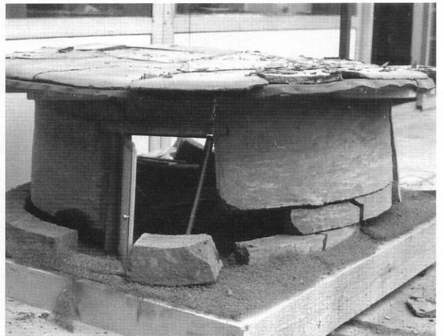
15.3-1 a 15.3-3 Ensayos con modelos de viviendas antisísmicas de tapial
