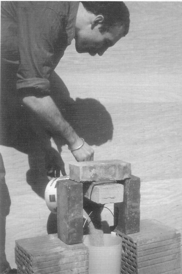
2.6-4 Ensayos de campo para determinar la cohesividad de un mortero de barro
