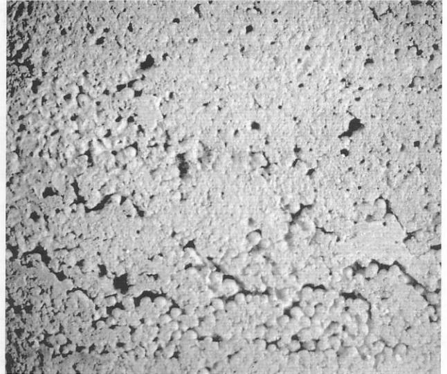
13.6-3 Superficie de un muro de barro alivianado con mineral con una densidad de 1000  $kg/m^3$  luego de quitar el molde
