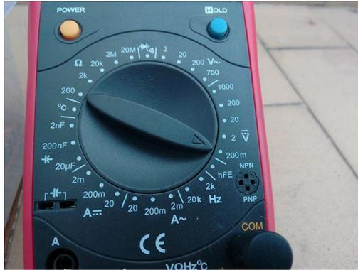
Ahora procedemos a estructurar la polaridad y las nano capas en el cobre, para ello se necesita un multímetro en la opción de corriente directa (DC) a una escala de 200 milivoltios. Con la
