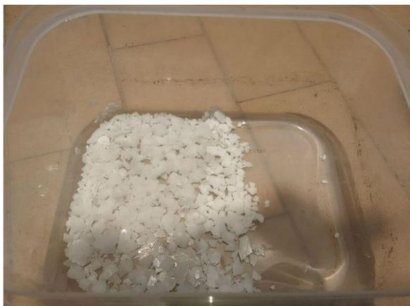
Nuevamente secamos el contenedor, agregamos NaOH en un 45% y el KOH en un 5%.
