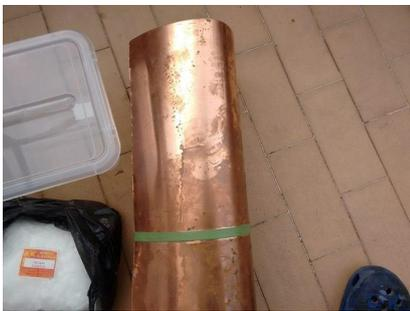
Lámina de cobre, de 1 a 0.5 milímetros de espesor.
