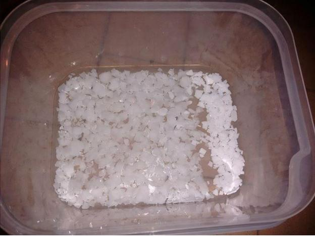
En la parte inferior del contenedor agregaremos en un 90% NaOH (como se puede ver en la parte izquierda) y de KOH un 10%.
