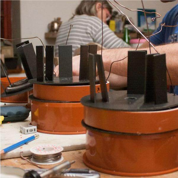
Coloque la placa inferior de la clavija y lo puso un anillo (3 cm de ancho, cortado de un tubo) como un espaciador y la placa inmediatamente superior. Desconecte el terminal positivo de la bobina inferior y el cable de cobre recubierto libremente a través de las escotaduras con oben. Quelle después: [www.Plasma-Energie.org](http://www.Plasma-Energie.org)
