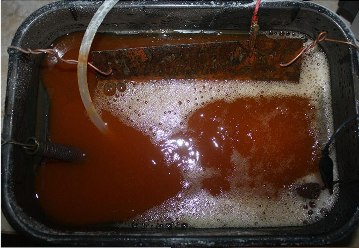
bobina de cobre recubierto de placas, oxígeno y 0,15 amperios de corriente (batería) fuente de hierro:
