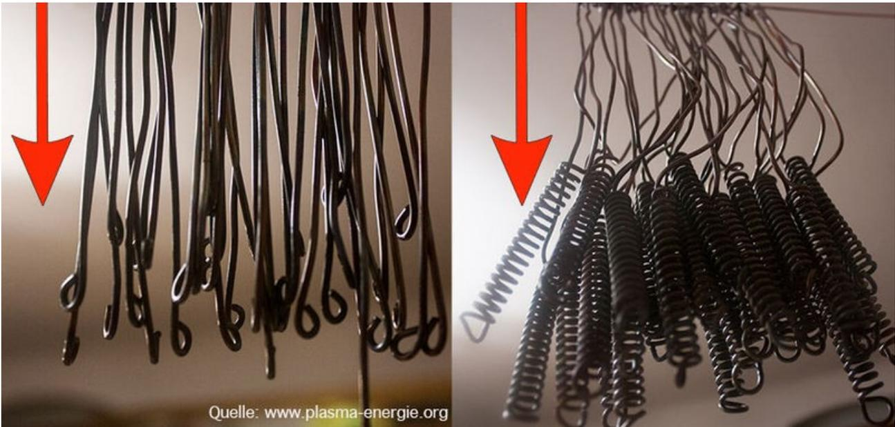
Feuercoaten partes de condensadores externos e internos, tenga en cuenta la dirección de recubrimiento y se señaló para el montaje! Fuente: www.Plasma-Energie.org
