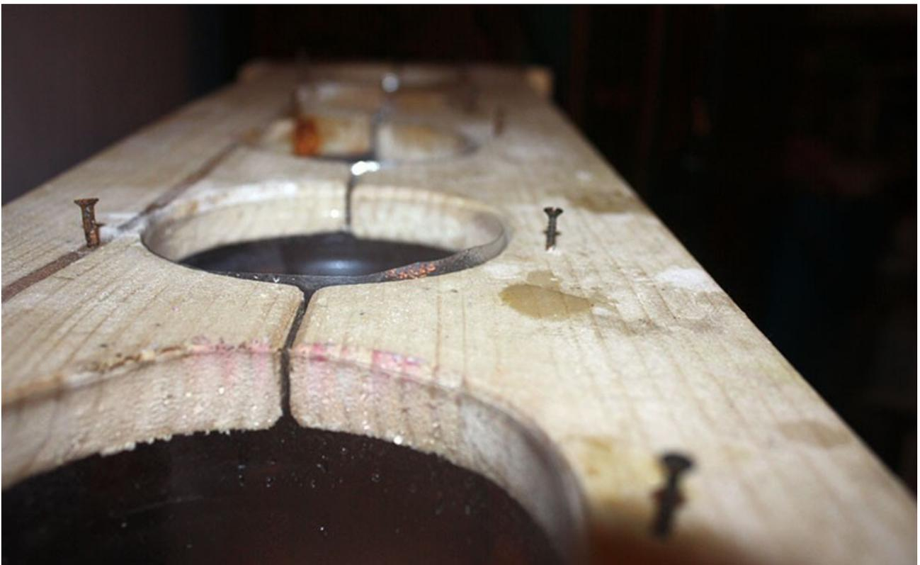
tornillos opuestos para la fijación de los metales (zinc, cobre, ....) Fuente: [www.Plasma-Energie.org](http://www.Plasma-Energie.org)
