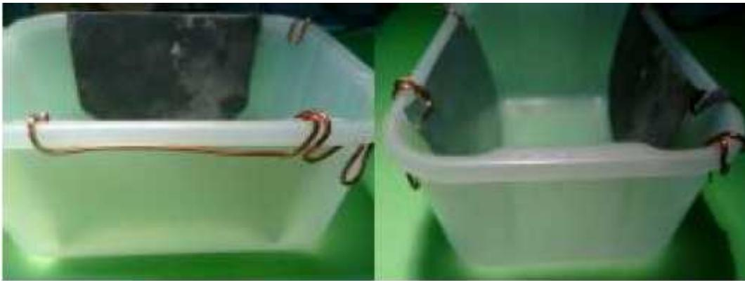
5. Conectamos ambas placas, de manera que dicha conexión quede fuera de la solución salina una vez que ésta se tuviese que verter en el recipiente.
