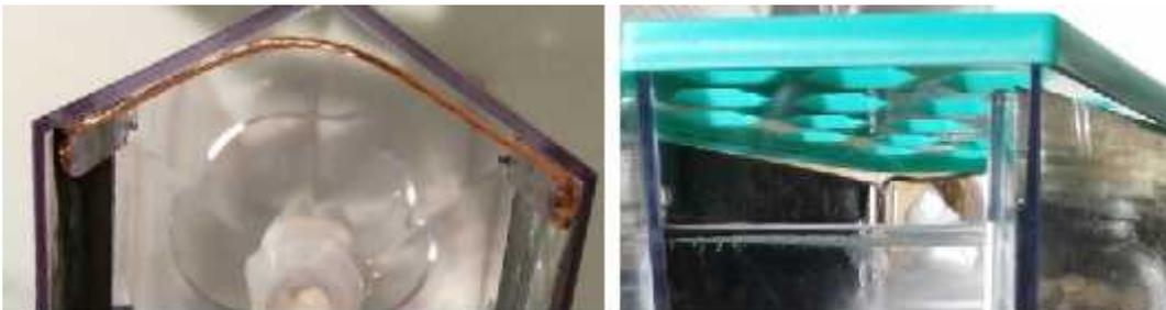
(\*imágenes que muestran la conexión *imagen izquierda* y la ubicación del cable fuera de la solución salina una vez vertida en el recipiente *imagen derecha* )
