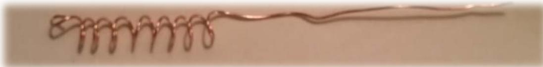
D. Tienes que girar el cable lado del que empezaste a enrollar el cable toma la punta y gírala sobre el cable de donde viene (el lado izquierdo del muelle).
