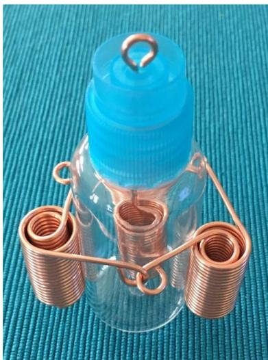
Asegure cada conexión y cada bobina en el contenedor con pegamento caliente .
