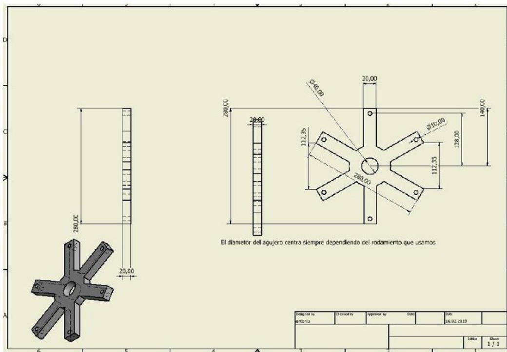
Construir dos anillas como soporte de los rodamientos, para fijarlo dentro de nuestra estrella en este caso el soporte de bobinas
