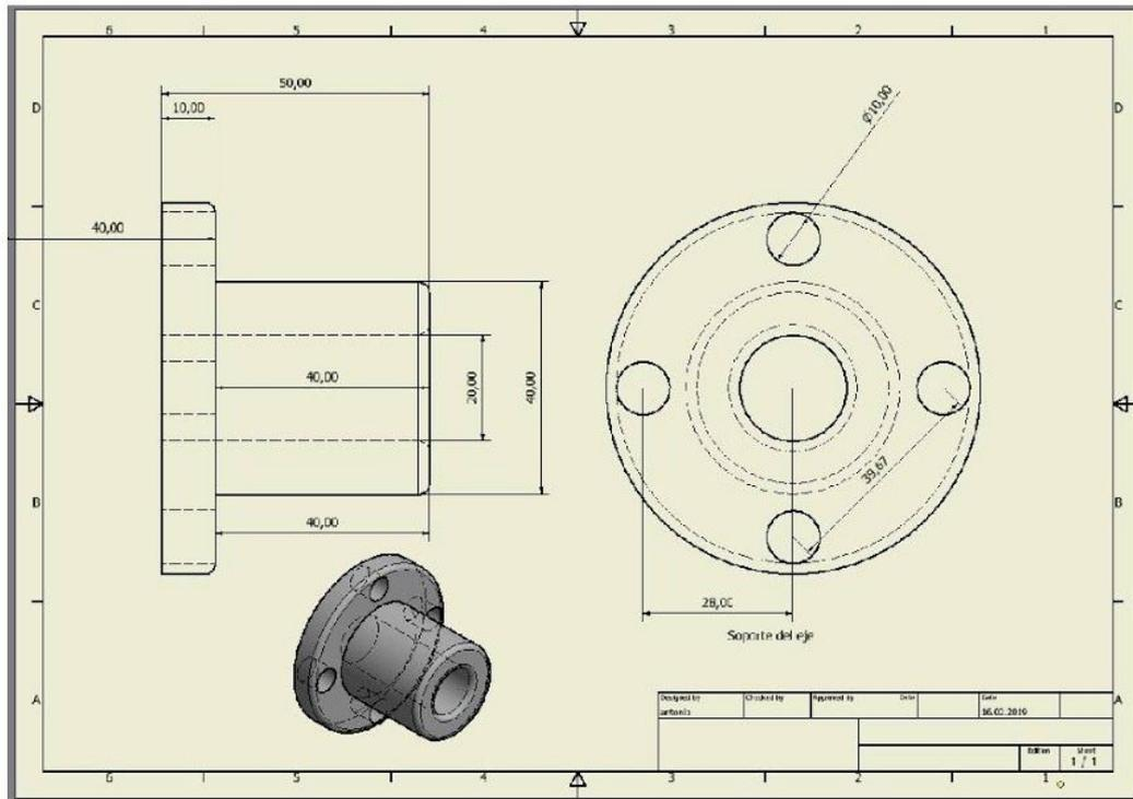
**El soporte del eje ir a fijado al rotor de los imanes, bien atornillado puede ser de PVC,PLA,ACERO, o en soldado,**
