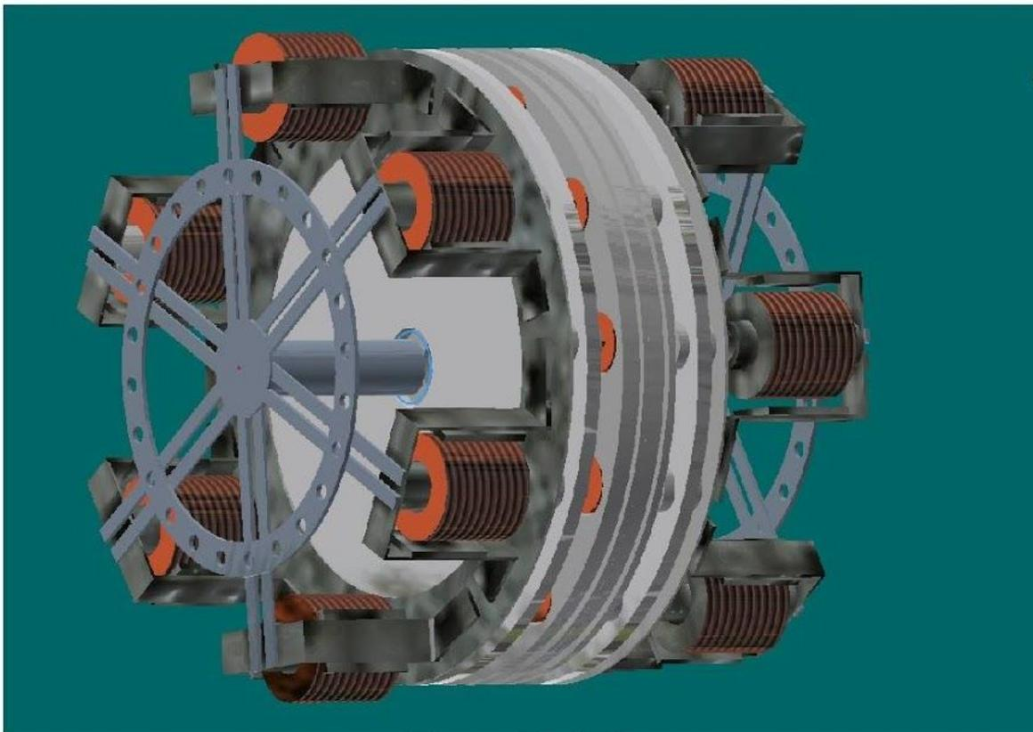
Aquí tenemos una segunda opción, donde podemos poner en el rotor central, lo mismo que tenemos en el rx18 es decir que podemos poner bobinas inductoras, para instalarle un sistema de movimiento, el cual va pulsando sobre los rotores laterales, y estos van girando Las bobinas laterales, y al mismo tiempo produciendo energía,
