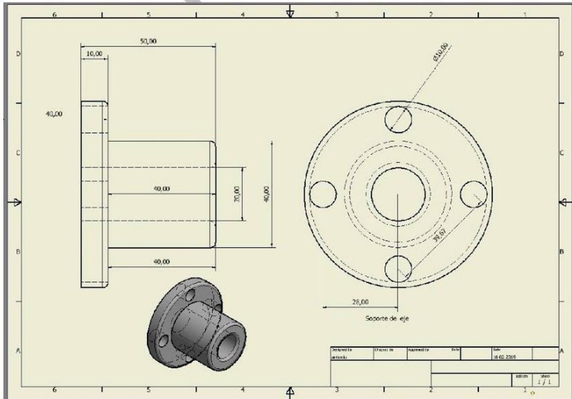
El soporte del eje, irá fijado al rotor de los imanes, bien atornillado o pegado con un pegamento adecuado u otro medio que lo fije; puede ser construido en PVC, PLA, ACERO, etc.
