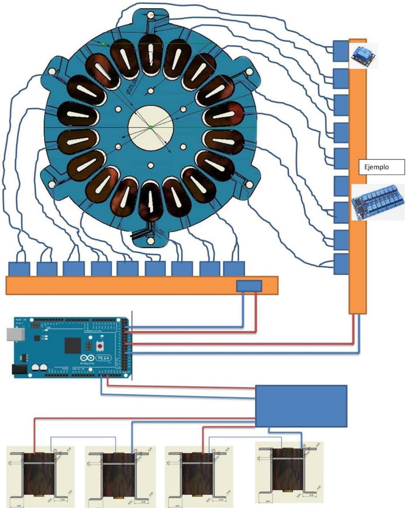
Usando las bobinas primarias como productora para el sistema de ARDUINO Y RELAY
